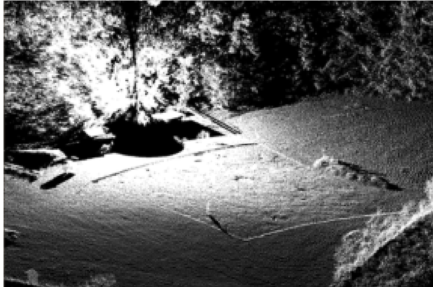
Abb. 91: Visualisierung der 3D-Punktwolke des Schnittes 5, Schwarzenbach-Burg erstellt aus einem Scan.
