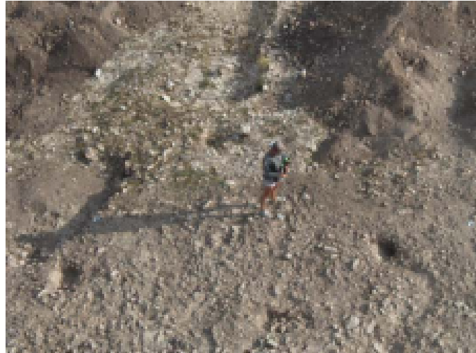
Abb. 84: Digitale Dokumentation von Schichtoberflächen mit einem Tachymeter und Reflektor.
